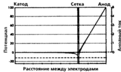
Смещение на сетке равно напряжению запертия Анодный ток 0,0
