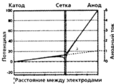
Нулевое смещение на сетке Анодный ток 1,1
