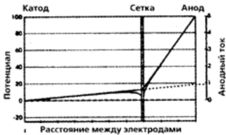
Нулевое смещение на сетке Анодный ток 0,9
