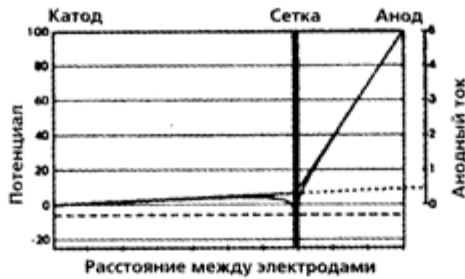
Смещение на сетке -1/2 напряжения запертия Анодный ток 0,5
