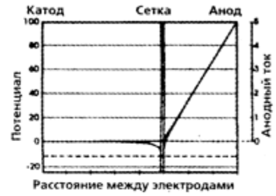
Смещение на сетке равно напряжению запертия Анодный ток 0,0
