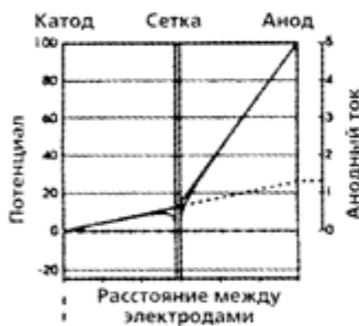
Нулевое смещение на сетке Анодный ток 1,2
