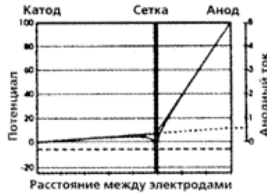
Смещение на сетке -1/2 напряжения запертия Анодный ток 0,6
