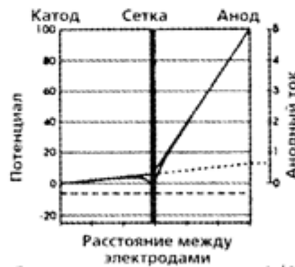
Смещение на сетке -1/2 напряжения запертия Анодный ток 0,7
