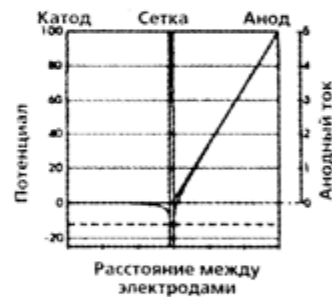
Смещение на сетке равно напряжению запертия Анодный ток 0,0
